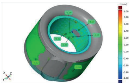
Abb. 10: Versuch 2, Höhendifferenz nach 3D-Vermessung von Lager 1 in [mm]
