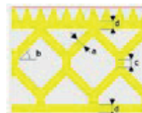
Abb. 4: Perforationsparameter: Stegbreite (a), Winkel (b), Höhe (c) und Solidhöhe (d) [13]
