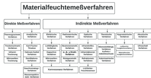
Abb. 1: Klassifizierung der Materialfeuchtemessverfahren (Quelle: In Anlehnung an (Kupfer, 1997))
