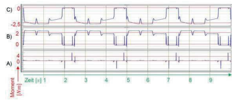
Abbildung 9 Servo Momente für ein Bein Krabbelbewegung, Es werden vier Schrittfolgen durchlaufen
